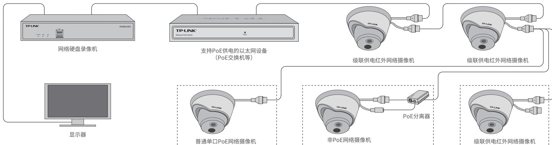
虚线框中的三种连接方式任选一种即可。如果最后一级连接级联供电红外网络摄像机，需封住OUT口以做防水保护，否则有短路风险。
